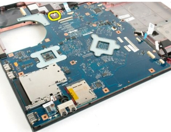
15. 시스템 보드를 컴퓨터 케이스에 고정하는 나사 3개를 분리합니다.
